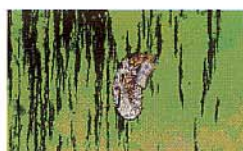
3. ábra. Fáradásos kopásból származó részecske
