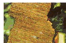
4. ábra. Csúszási súrlódásból származó részecske
