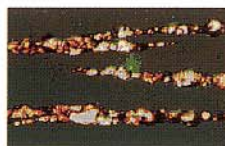
1. ábra. Normál kopásból származó részecskék
